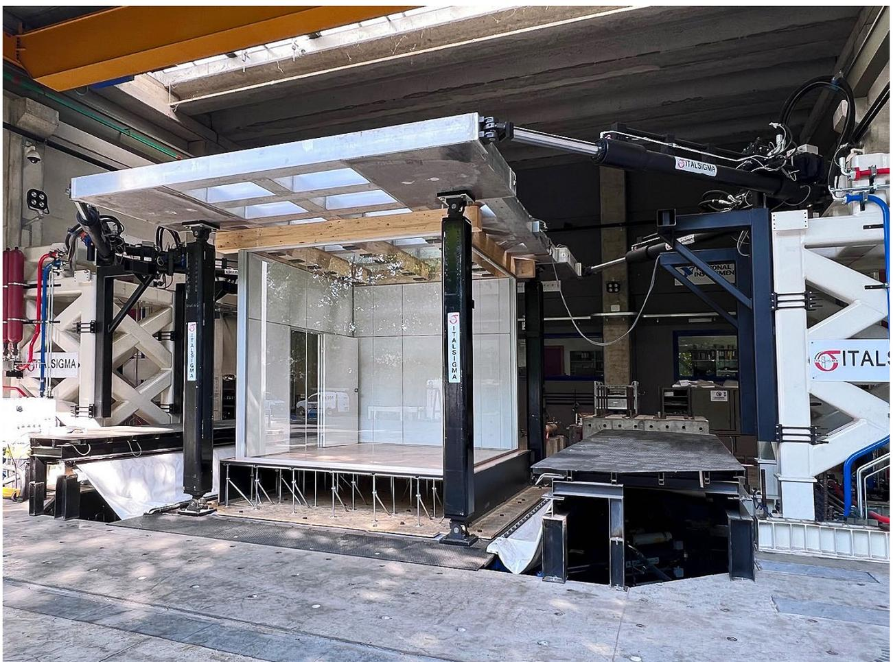
Assemblaggio degli elementi non strutturali (pareti divisorie in vetro e pavimento galleggiante) che verranno testati nell'evento dell'8 giugno.
