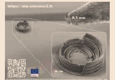
Un micro-Colosseo, realizzato tramite litografia a doppio fotone, posto in prossimità della punta di un ago (immagine al microscopio elettronico)
