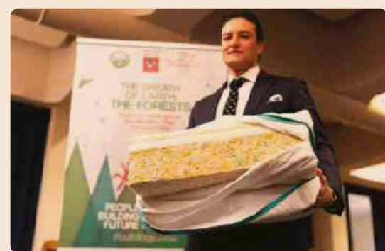
Imbottitura per materassi a base di scarti di poliuretano flessibile
